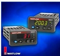
Представленные с размерами DIN 1/32, 1/16, 1/8 и 1/4, одноканальные самонастраивающиеся температурные контроллеры компании Watlow автоматически устанавливают контрольные параметры ПИД-регулятора для оптимальной системной производительности. Возможна ручная настройка режимов включения-выключения, П, PI или ПИД регулирования. Все самонастраивающиеся регуляторы компании Watlow спроектированы и произведены с устойчивостью к жестким промышленным средам с гарантией 3 года.
