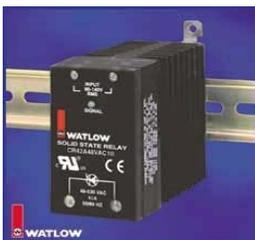
Серия твердотельных реле CZR компании Watlow служит для коммутации электрических цепей нагревателей. Выпускаются с двумя способами крепления - панельный и на DIN-рейку. Ток коммутации - 24..50А с кратковременными скачками напряжения до 600V.
