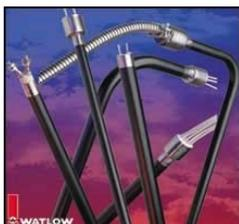
Многосекционные нагреватели от Watlow характеризуются применением при экстремально высоких температурах процесса. Независимые нагревательные цепи позволяют применять нагреватели в областях с температурным уклоном. Для более удобного монтажа и демонтажа в конструкции предусмотрена посадка с зазором. Передача тепла на плиты реализуется посредством излучения.
